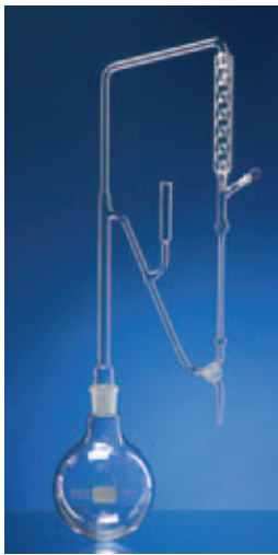
APPARATUR ZUR BESTIMMUNG DER ÄTHERISCHEN ÖLE IN DROGEN nach DAB (10.Auflage) bestehend aus komplettem Destillationsaufsatz mit Kern NS 29/32, Allihn-Kugelkühler, Entlüftungsstopfen NS 7/16, Meßrohr 1 ml : 0,01 ml mit Kugel (3 ml) oberhalb des Nullpunktes und Czako-Dreiweghahn, mit Rundkolben 1000 ml, NS 29/32
