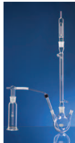
BESTIMMUNG VON CYANIDEN (D13, D 14) DIN 38 405 Teil 13+14 (DEV) bestehend aus Dreihalskolben, Liebigkühler, Gaswaschflasche, Einfülltrichter und Absorptionsgefäß
