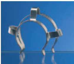
SCHLIFFKLAMMERN, KECK FÜR KEGELSCHLIFFE aus Federstahl
