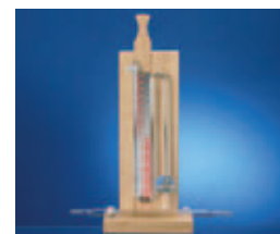
VAKUUMMETER NACH BENNETT auf Holzstativ mit verschiebbarer Skala
