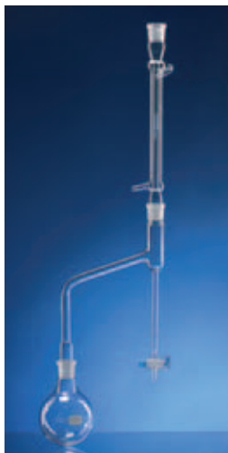
APPARATUR ZUR BESTIMMUNG DES WASSERGEHALTES (Toulol-Methode) nach DAB (10. Auflage) bestehend aus Rundkolben, Meßrohr mit Hahn und Liebigkühler
