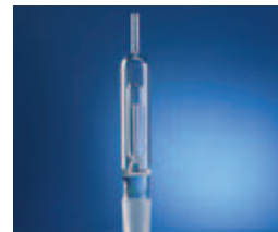
ABSORPTIONSGEFÄß ZUR BESTIMMUNG VON: CYANIDEN (D13 + D14) SÄURELÖSLICHEM ANTEIL VON METALLEN (S 7) PHOSPHOR IN SCHLÄMMEN UND SEDI-MENTEN (S 12) DIN 38 405 - Teil 13+14 (DEV) DIN 38 414 - Teil 7 + 12 (DEV)
