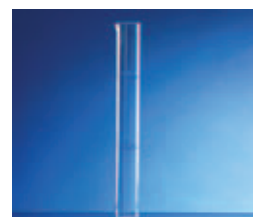
COLORIMETERZYLINDER NACH NESSLER mit aufgeschmolzener, optisch reiner Bodenplatte, mit Ausguß
