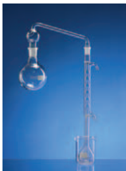
APPARATUR ZUR BESTIMMUNG DES ETHANOLGEHALTES nach DAB (10. Auflage) bestehend aus Rundkolben, Destillationsbrücke mit Tropfenfänger, Kugelkühler, Meßkolben und Becherglas
