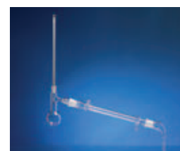
APPARATUR ZUR BESTIMMUNG DES DISTILLATIONSBEREICHES nach DAB (10. Auflage) bestehend aus Destillierkol- ben, Thermometer, Liebig- kühler und Destilliervorstoß
