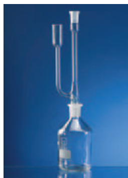
BESTIMMUNG VON LEICHTFLÜCHTIGEN HALOGENKOHLENWASSERSTOFFEN (LHKW) (F 4) APPARATUR ZUR BESTIMMUNG VON BENZOL (F 9) DIN 38 407 - Teil 4 + 9 (DEV) bestehend aus Mikroseparator und Vorratsflasche
