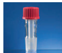
KPG-LAGERHÜLSEN mit Gewinderohr und NS-Kern
