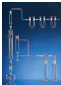
BESTIMMUNG DER SUMME DES GELÖSTEN KOHLEN-DIOXIDS (G 1) DIN 38 408 Teil 1 (DEV) bestehend aus Stehkolben, Gaswaschflaschen, Tropftrichter, Gaswaschlocke, Trockenrohre, Schlangenkühler, Gaseinleitungsrohr, Absorptionsgefäß, Gravimetrisches Verfahren
