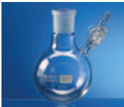
STICKSTOFF-RUNDKOLBEN (SCHLENKKOLBEN) Hals mit NS-Hülse, seitlicher Hahn mit massivem Glasküken und Olive
