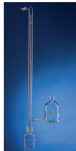
BESTIMMUNG DES FAULVERHALTENS (S 8) DIN 38 414 Teil 8 (DEV) bestehend aus Vorratsflasche, Eudiometerrohr und Niveaugefäß
