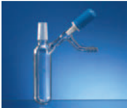
STICKSTOFF-VORLAGEN (SCHLENKROHRE) MIT VENTILHAHN Hals mit NS-Kern
